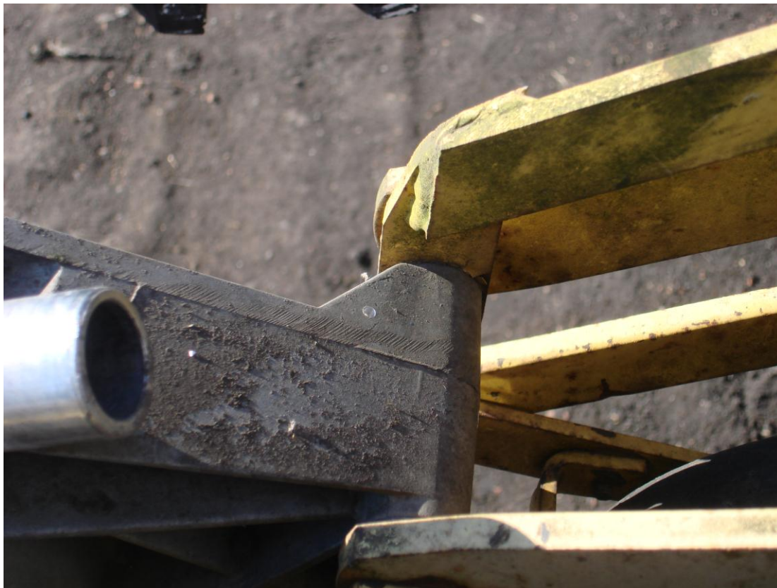
Рис.3б. Отверстия в корпусе высевающего аппарата для крепления проводки датчика высева
