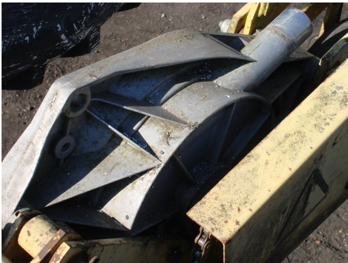
Рис.3а. Отверстия в корпусе высевяющего аппарата для крепления проводки датчика высева
