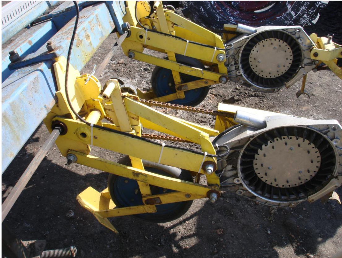
Рис.3г. Крепление проводки датчика высева к корпусу высевающего аппарата и параллелограммнику
