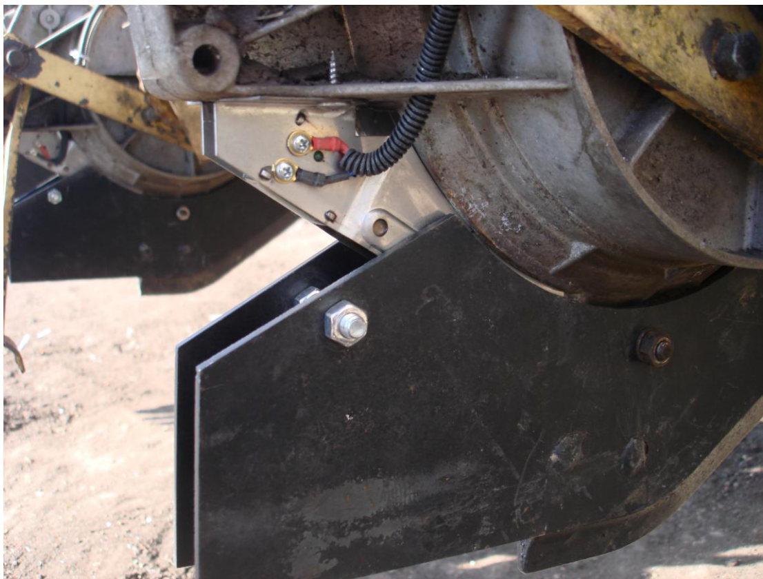
Рис.3д. Установка датчика высева на корпусе высевающего аппарата
